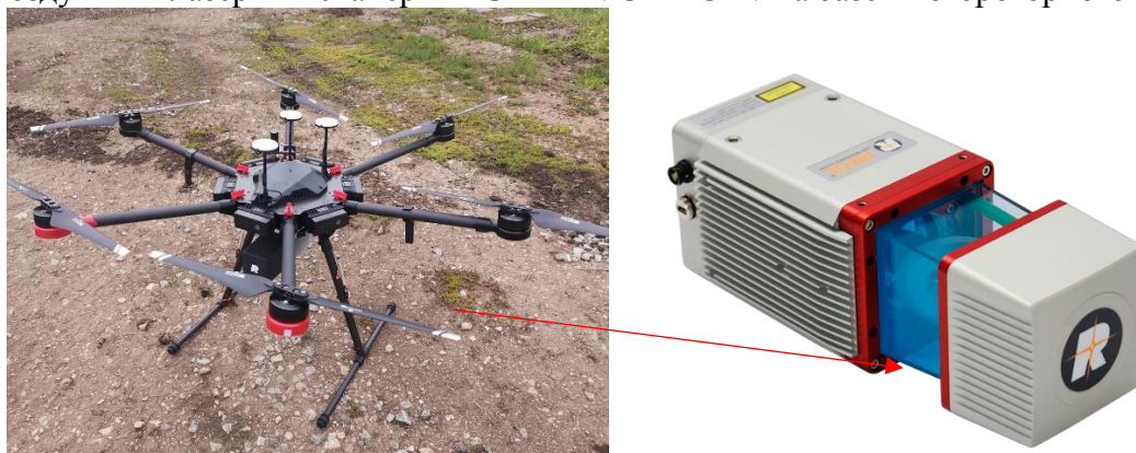
Рис.2. RIEGLminiVUX-2UAV на базе БПЛА Matrice M600
