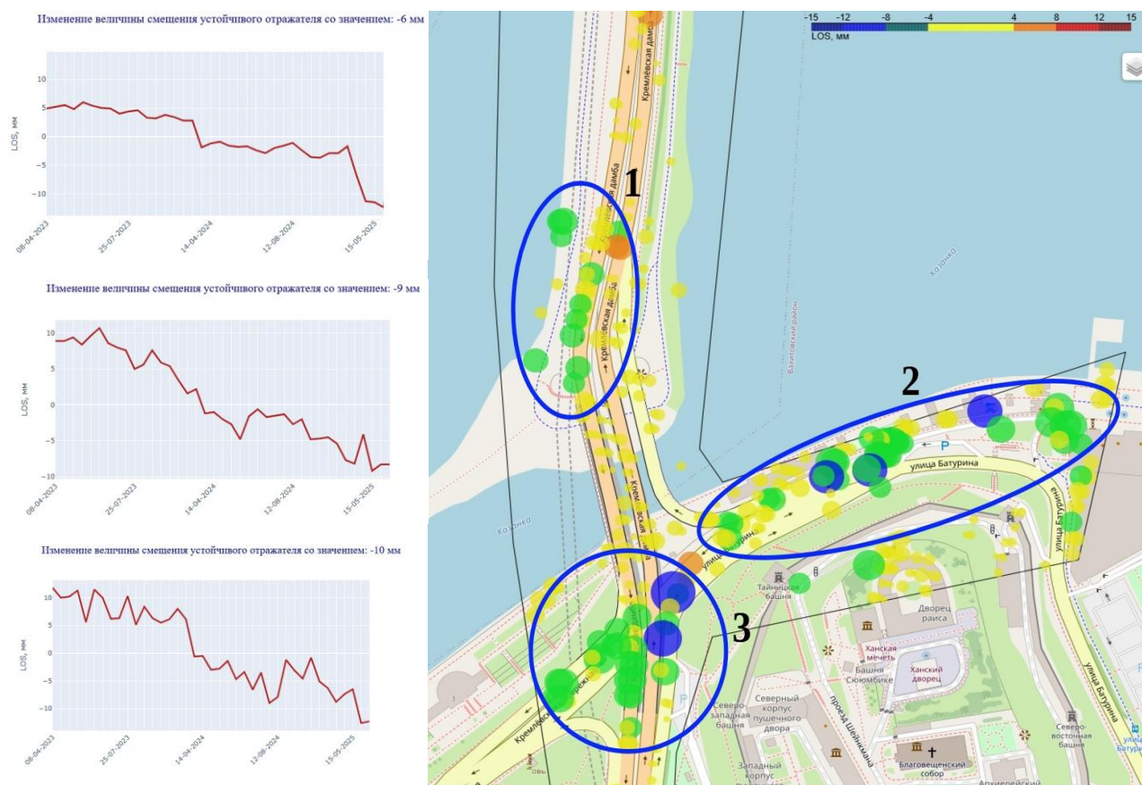
Рис. 2. Представлены устойчивые отражатели, выявленные для развязки кремлевской дамбы, и графики смещения для точек трех областей деформаций
