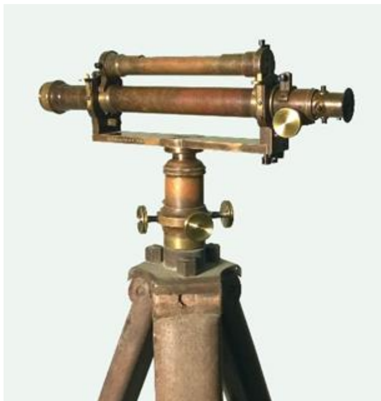
Рис. 2. Нивелир, схожий по конструкции с нивелиром Штампфера (источник фото: музей Kern Aarau; г. Аарау, Швейцария)
