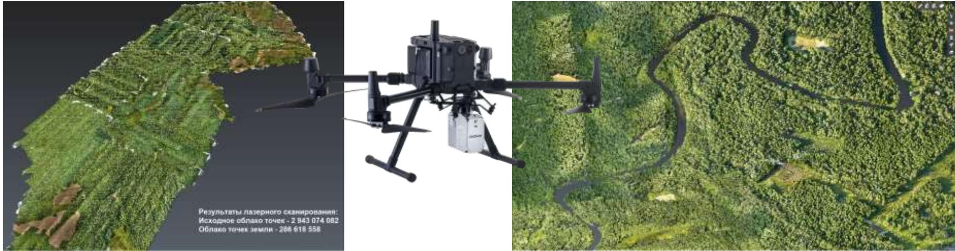
Работы по воздушному лазерному сканированию выполнялись с использованием роботизированного комплекса, состоящего из платформы DJI Matrice 350RTK и лидара AlfaAir 450. Производительность данного комплекса составляет 15–20 кв. км в день в зависимости от сложности логистики объекта и погодных условий. Площадь участка — 20 кв.км, плотность ТЛО — 140 точек/кв.м, плотность точек «земли» - 14 точек/кв.км. Время сканирования — 2 рабочих дня, точность определения высот — 5 см.
