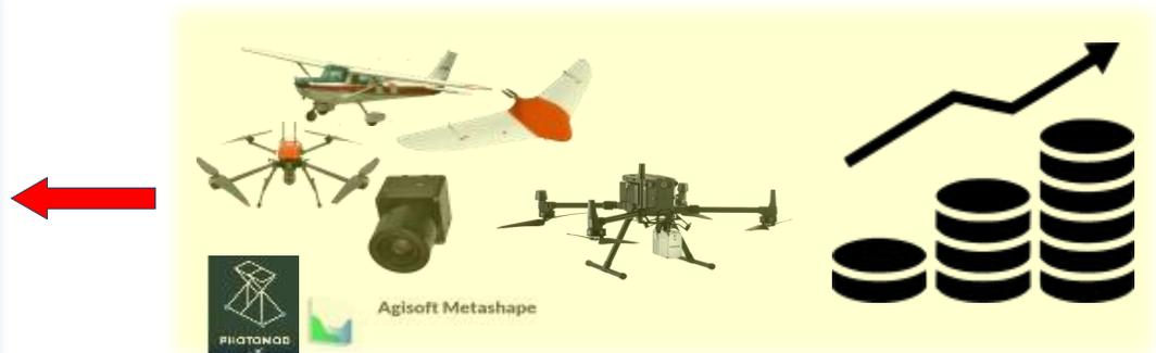
Комплексное использование ЦАФС и ВЛС позволяет многократно сократить стоимость и сроки создания цифровых топографических планов наиболее востребованных при проектировании масштабов 1:500 — 1:2000. В среднем стоимость работ с использованием ВЛС и ЦАФС составляет 25-30% стоимости работ с использованием традиционных технологий. Сроки работ сокращаются на порядок.
