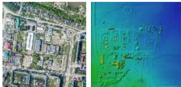
1. Комплексное использование данных ВЛС совместно с ЦАФС позволяет получить максимум данных в камеральных условиях с использованием цифровых фотограмметрических моделей, точек лазерных отражений, ортофотопланов и ЦМР.
