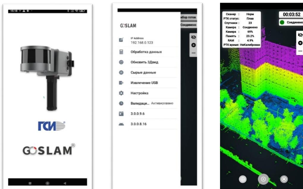
В комплекте со сканером поставляется программное обеспечение GoSLAM LidarWorks, которое является неотъемлемой частью системы сканирования. Лицензия предоставляется постоянная, с возможностью переноса на другие компьютеры. Из основного функционала хочется отметить автоматическое удаление шумов, редактирование облаков, привязка данных в местную систему координат, подсчет объемов, измерения, простейшая векторизация.
