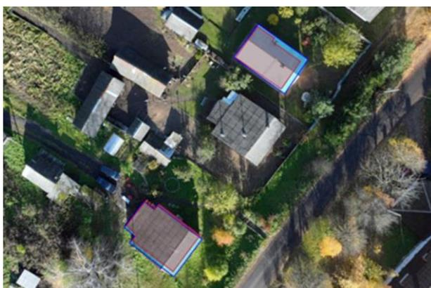
Рис. 1. Разница измерений по фундаменту и по коньку крыши
