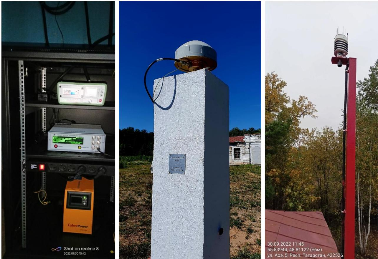
Рис. 2. Пункт ФАГС ОКТВ (Приемник, монумент с антенной и метеостанция)
