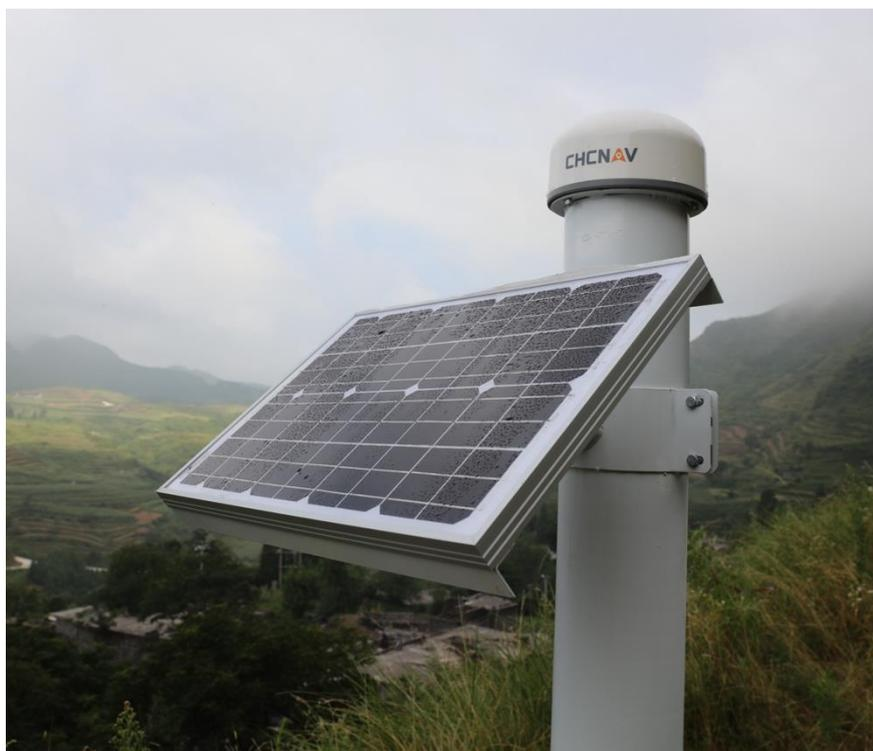
Рис. 1. ГНСС-приемник для наблюдения деформационных процессов CHCNAV H3
