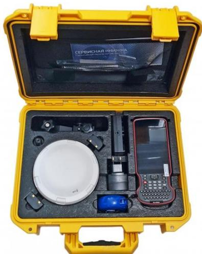
В состав комплекта входит: спутниковый приемник SinoGNSS MARS, 2 Li-ion аккумулятора, зарядное устройство с блоком питания, кабель передачи данных USB, 2 УКВ-антенны, транспортировочный кейс, втулка для адаптера трегера, рулетка, полевой контроллер R60, программное обеспечение Survey Master, веха для установки ГНСС-приемника, крепление контроллера на веху.
